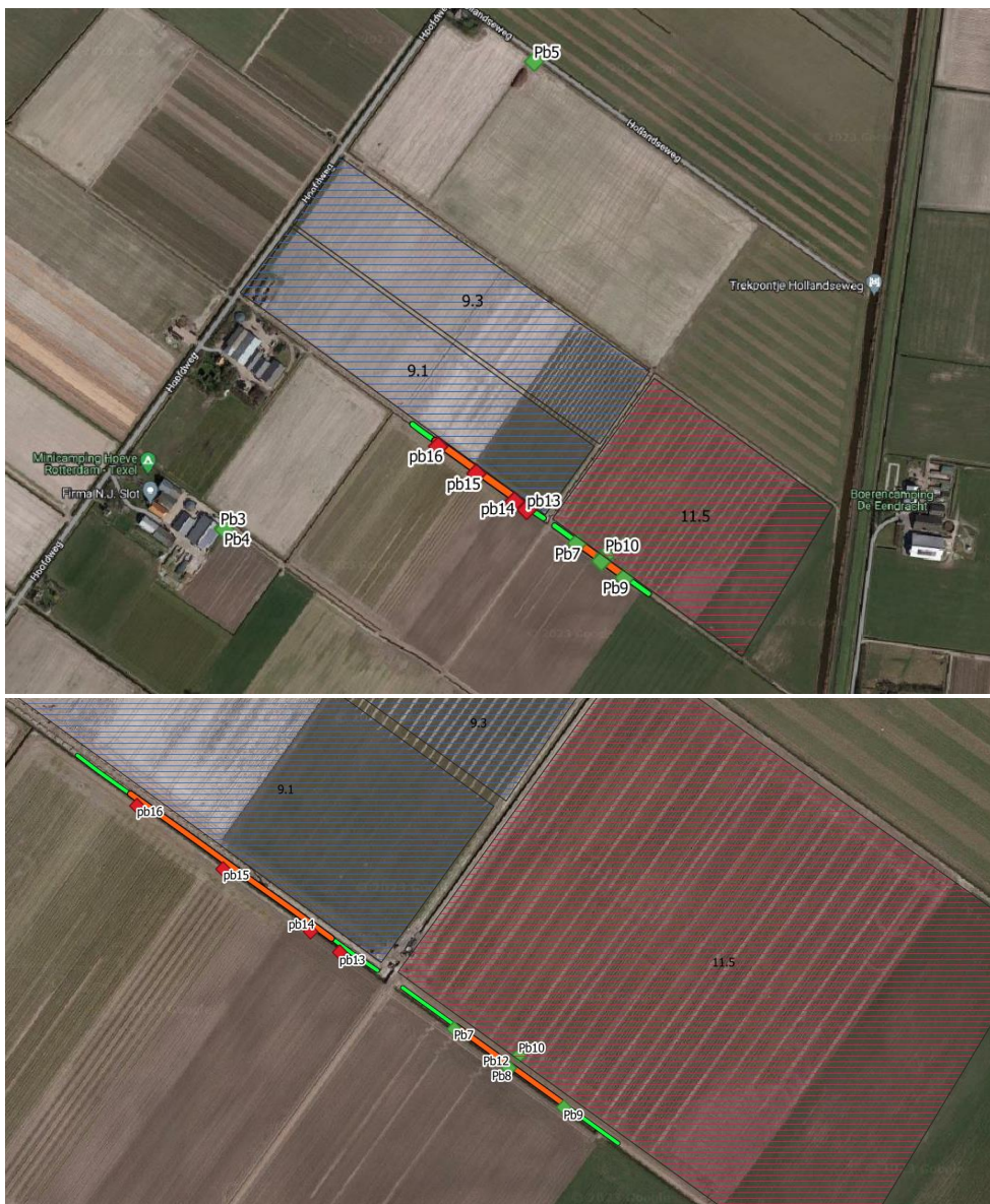
Figuur 22. Ligging van de beide HDDWs op locatie Hoofdweg en de geplaatste monitoringspeilbuizen (boven), verder ingezoomd op de HDDWs (onder). Het filtertraject is in rood aangegeven, de blinde buis naar maaiveld in groen buis.
