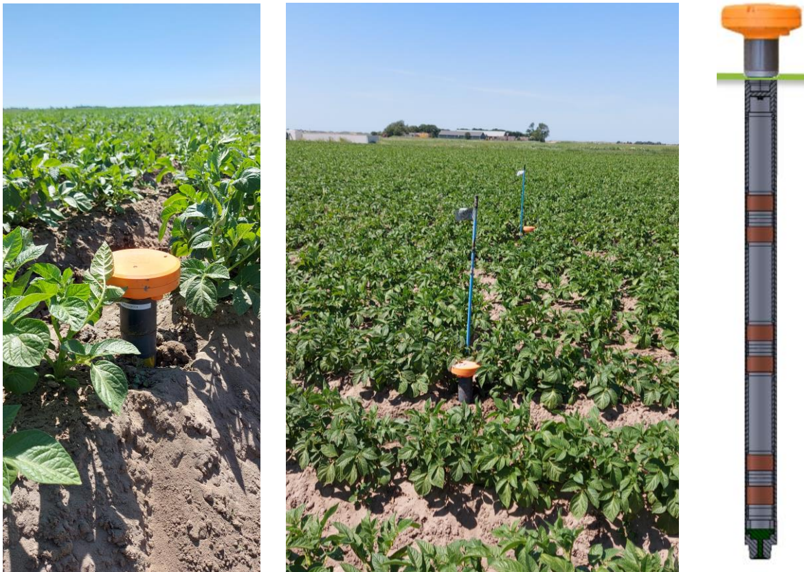
Figuur 40. Van links naar rechts: Een AquaPin in een aardappelrug op het proefperceel; twee AquaPins op 4 m afstand van elkaar op het proefperceel; een schematisering van een AquaPin met sensoren op verschillende dieptes.
