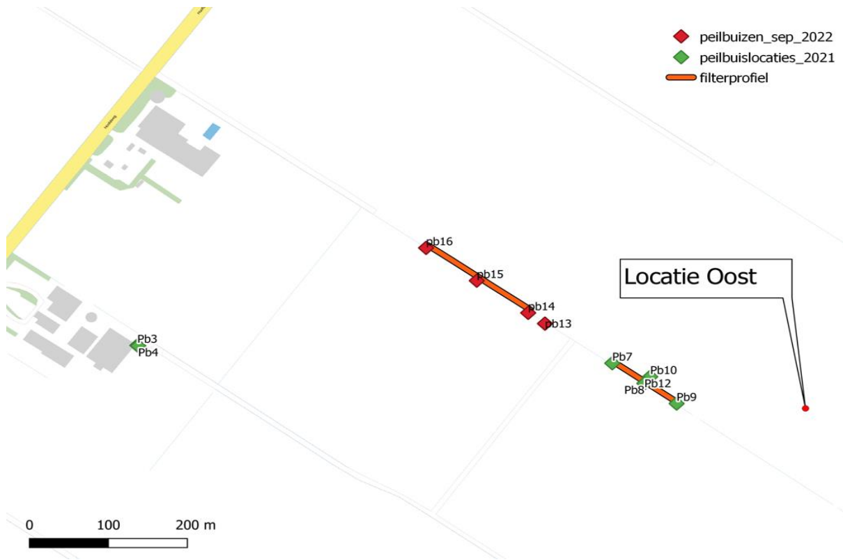
Figuur 16. Ligging van de monitoringspeilbuizen langs beide diepdraains op locatie Hoofdweg
