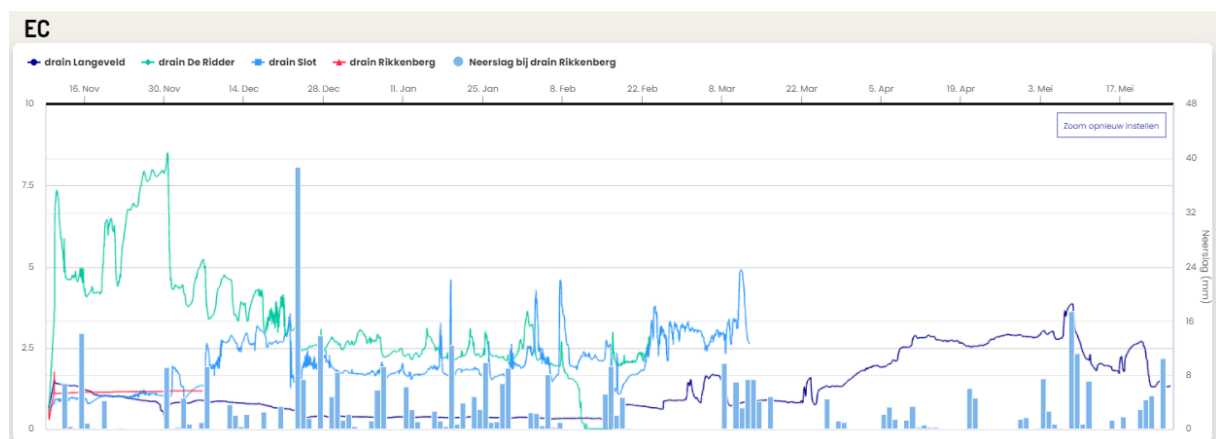
Figuur 21. De gemeten EC in vier verschillende drains, uitgezet tegen de neerslag
