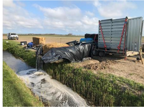
Figuur 27. Strofilter gebruikt bij de afvoer van het onttrekkingswater bij de pompproef
